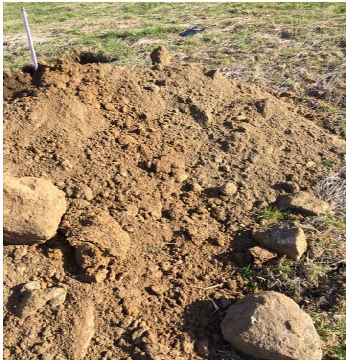
**Abb. 8: Baggerschurf BS 2, Aushub, Steine mit Blockgrößen (hier Kantenlänge 40 cm)**
