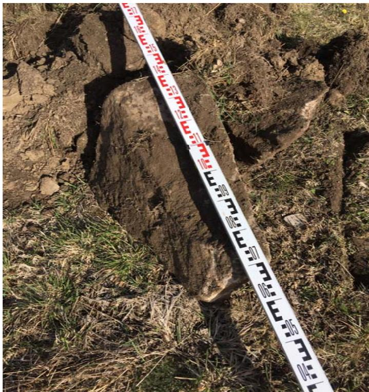
**Abb. 12: Baggerschurf BS 4, Aushub, Steine mit Blockgrößen (hier Kantenlänge 70 cm)**
