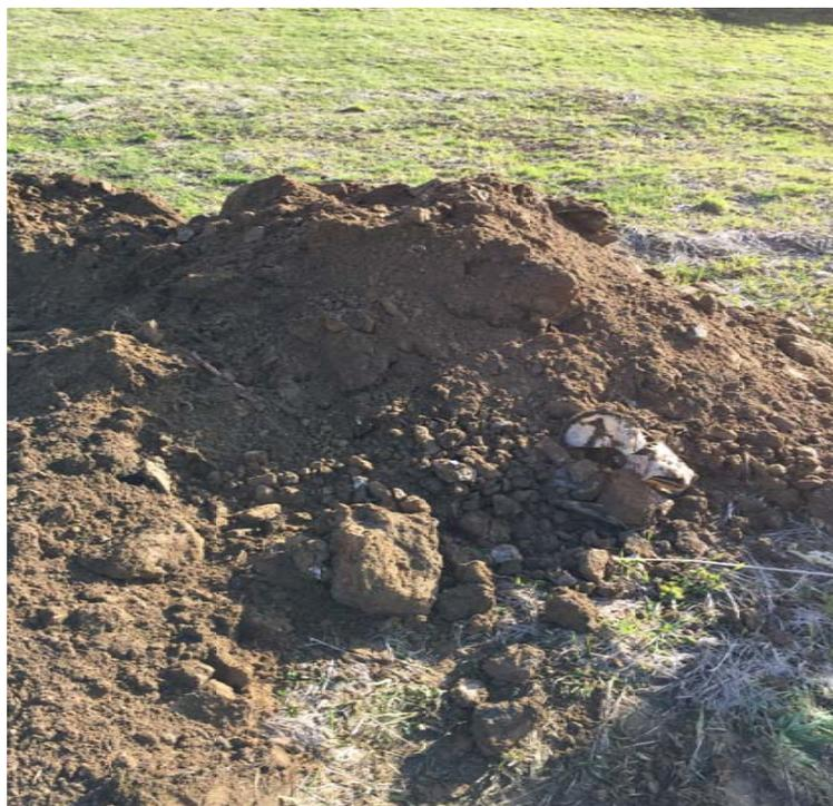
**Abb. 6: Baggerschurf BS 1, Aushub Auffüllungen, Steine mit Blockgröße (hier Kantenlänge 30 cm). Fremdbestandteile < 5 M% (Ziegelbruch, Asphaltbruch, Glasbruch, Plastik)**
