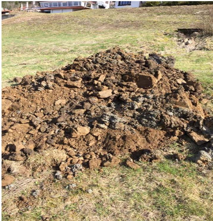
**Abb. 14: Baggerschurf BS 5, Aushub, Steine mit Blockgrößen (hier Kantenlänge 50 cm)**
